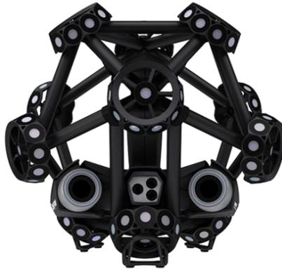
Сканирование может производить как робот-манипулятор (даже на конвейере), так и человек вручную. По окончании сканирования мы получаем 3D-модель в виде облака точек, а в дальнейшем файл в формате STL или OBJ, из которого можно достать нужную конструкторскую документацию, можно снять размеры, и проводить измерения объектов или деталей.
