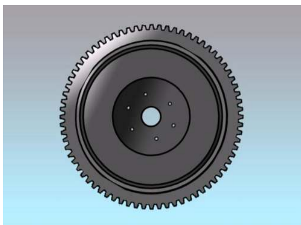
Рис. 1. Общий вид двухмассового маховика.
