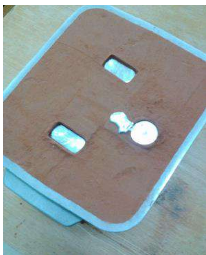
Рис. 5 – Литейную форму заливаем горячим металлом и охлаждаем
